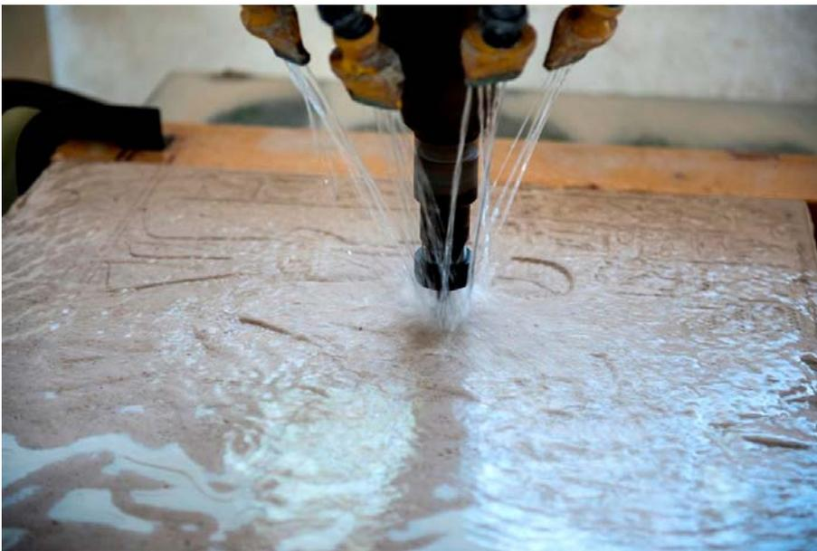
Figura 8- Lavorazione di fresatura con fresatrice a 3 assi a portale
